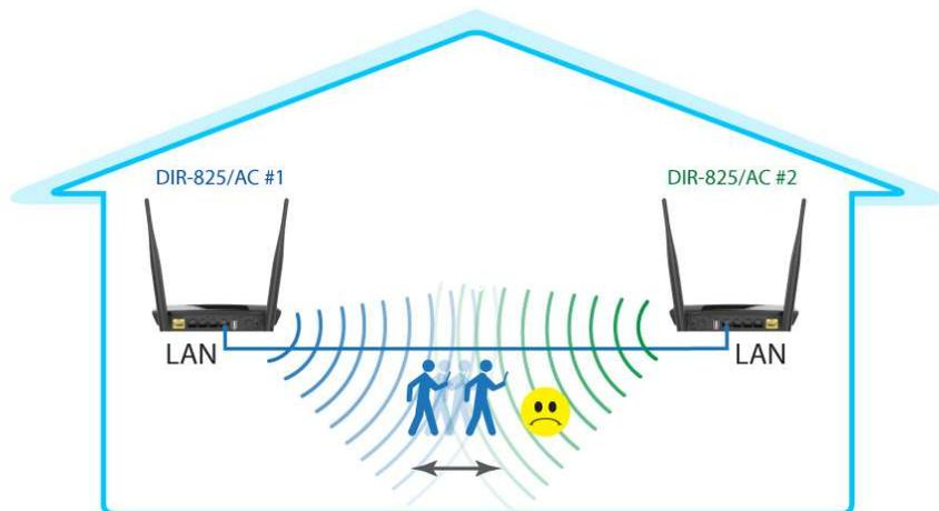
Если клиент не умеет самостоятельно переключаться к сети с более высоким уровнем сигнала, то он останется подключенным к ТД#1 на низкой скорости соединения
