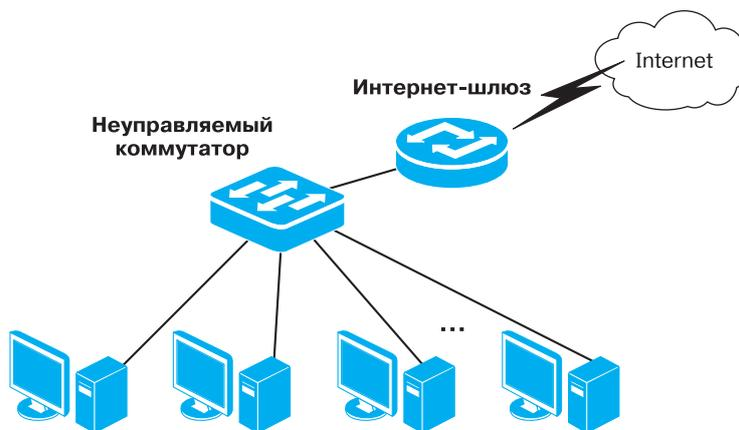
**Рис. 10.1.** Неуправляемый коммутатор D-Link в сети небольшой рабочей группы
